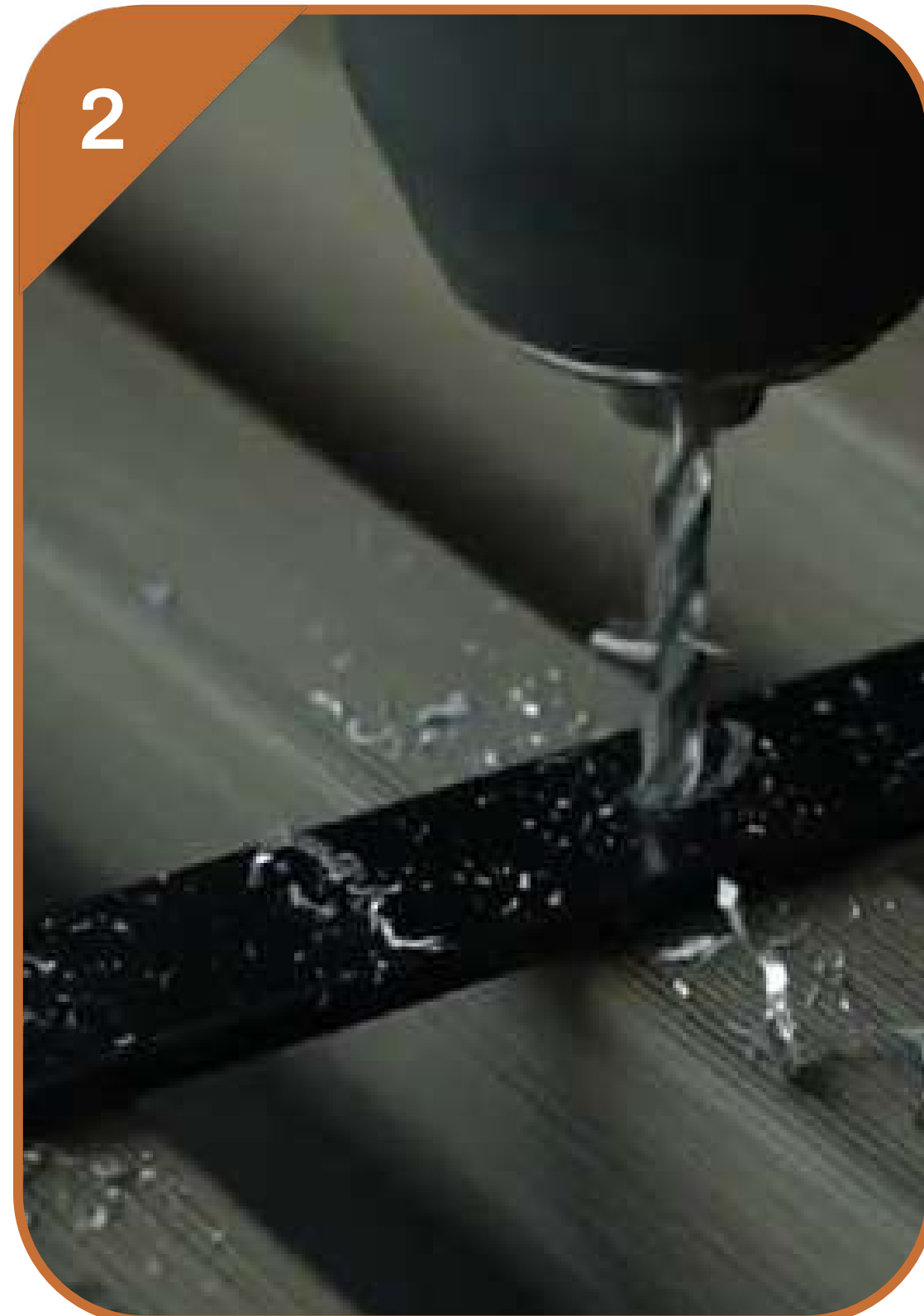
FIJACIÓN EN PERFIL METÁLICO PLANO
