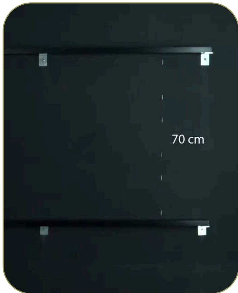
CÁLCULO DE LA DISTANCIA ENTRE SUBESTRUCTURAS PARA PANELES RIPADOS
